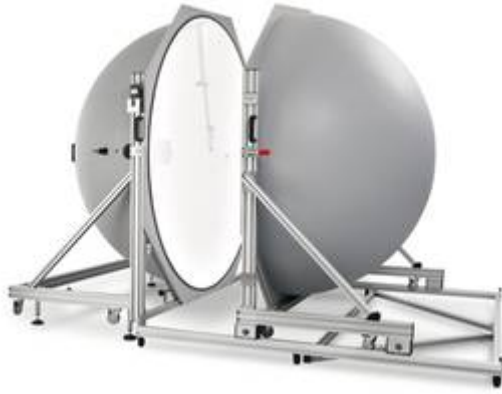
Abbildung 1: Die Ulbricht-Kugel ISP 2000 eignet sich in Kombination mit dem CAS 140D ideal zur Messung der korrelierten Farbtemperatur CCT und des Color-Rendering-Index CRI.
