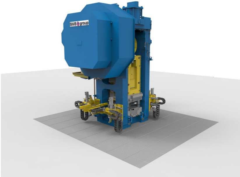
SMS group-Exzenterschmiedepresse MP 5000 für Dongfeng Forging.
