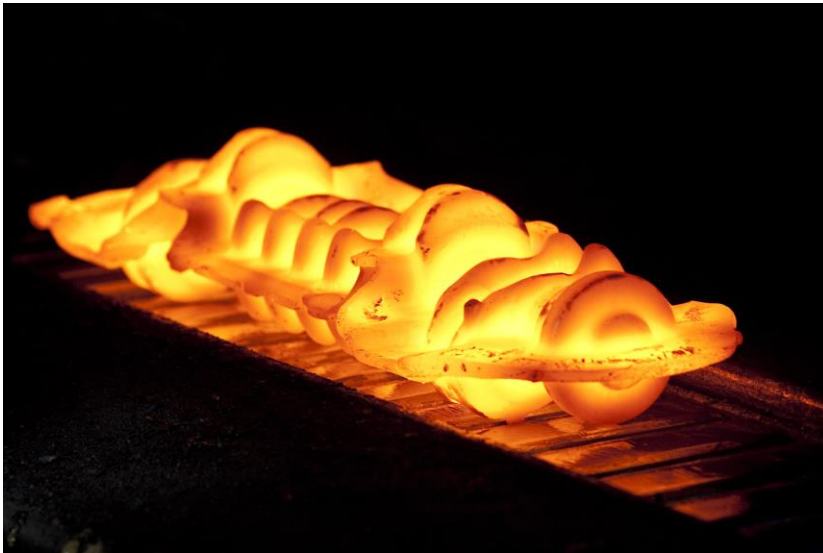
Auf der neuen MP 5000 von der SMS group will Dongfeng Forging zukünftig Kurbelwellen schmieden.
