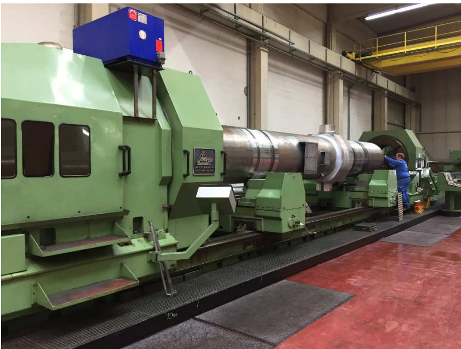
Innen- Honbearbeitung des Zylinderrohres, Quelle Hunger
