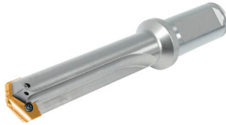
Bild Nr. 09-02 AO_SharkDrill.jpg. SHARK-Drill von ARNO Werkzeuge ist ein Schneidplattenbohrer für Durchmesser 9,5-114 mm
