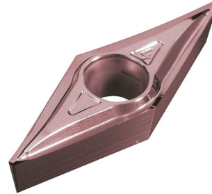
Bilder Nr. 10-05a AO_EB-WSP-Alu + 10-05b AO_EB-WSP-ASF Hochpositive Wendeschneidplatten vom Marktführer ARNO Werkzeuge schaffen beste Oberflächengüte durch geschliffenen Umfang und polierte Oberflächen für optimalen Spanabfluss.
