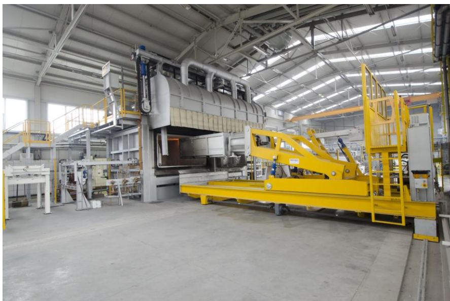
Mehrkammerschmelzofen mit Vorwärmrampe (Ecomelt PR) von Hertwich. (Beispielbild).
