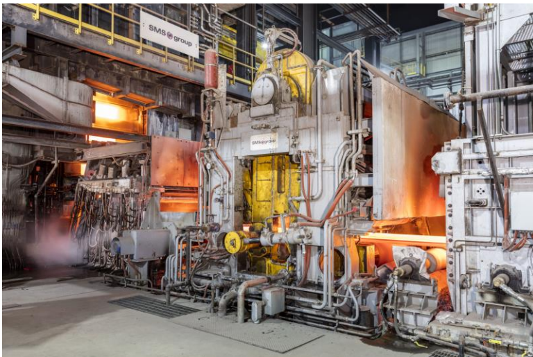
Bild einer vergleichbaren Dünnbrammengießanlage in Produktion.
