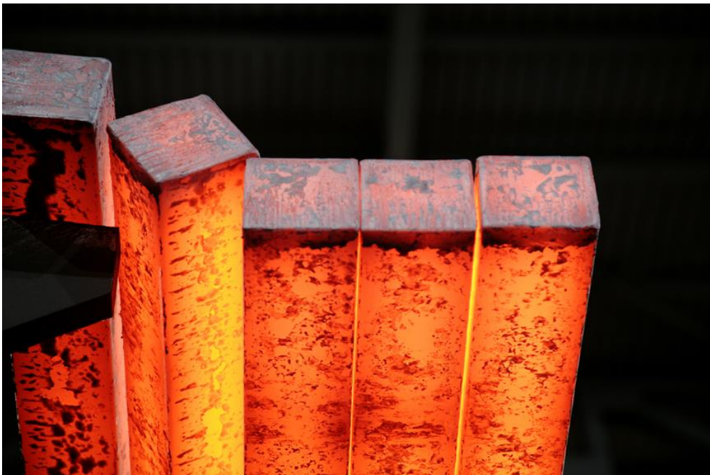
Auf einer SMS Concast-Stranggießanlage hergestellte Knüppel.
