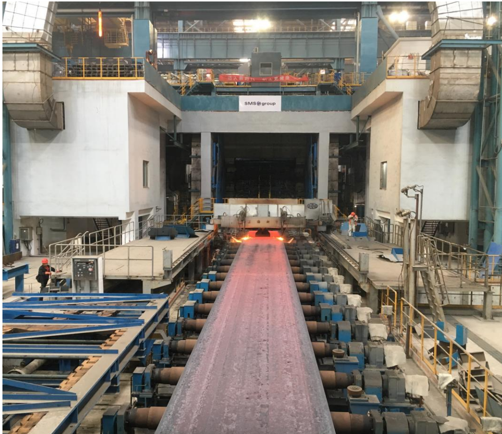
Die erste produzierte Bramme auf der neuen Stranggießanlage.
