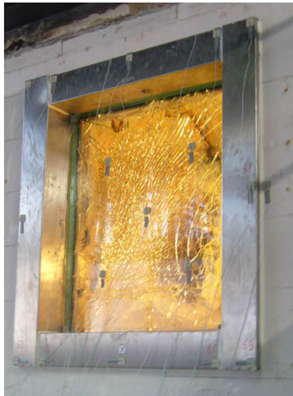
Bild Nr. 35-06 WU_BrandtestSolo.jpg. Wurster kann für die Festverglasung F120 nach bestandener Prüfung das amtliche Zertifikat vorweisen.
