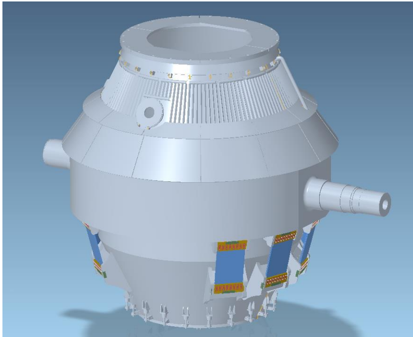
Konverter mit Lamellenaufhängung der SMS group.
