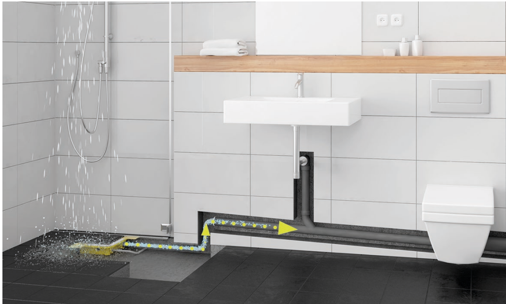
Bild 2: Das Duschabwasser läuft in den Plancofix-Behälter und wird in das höherliegende Abwasserrohr gepumpt
