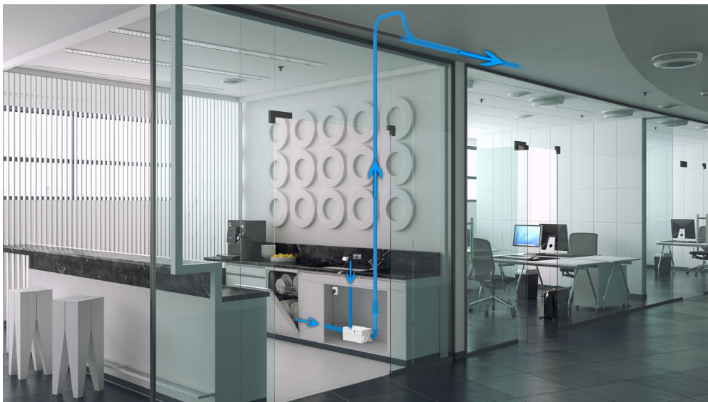
Abb. 3: Der Hebefix Mini entsorgt das Schmutzwasser einer Teeküche in einem Großraumbüro
