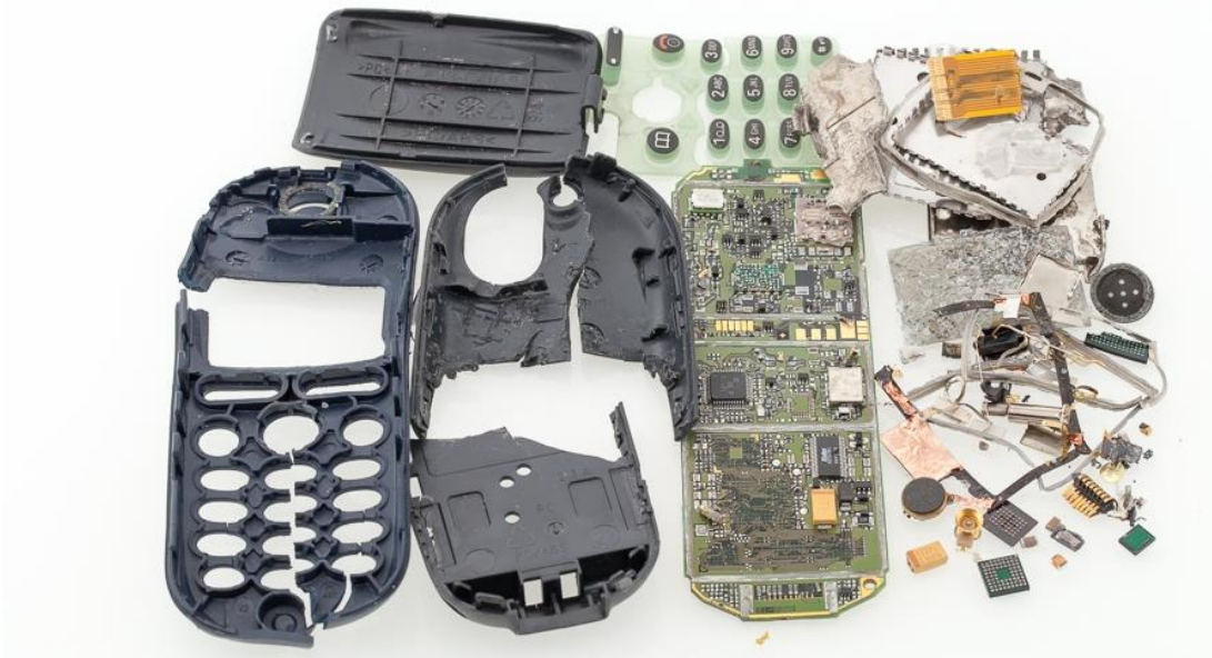
Mobiltelefon nach Anwendung des Schockwellenverfahrens
