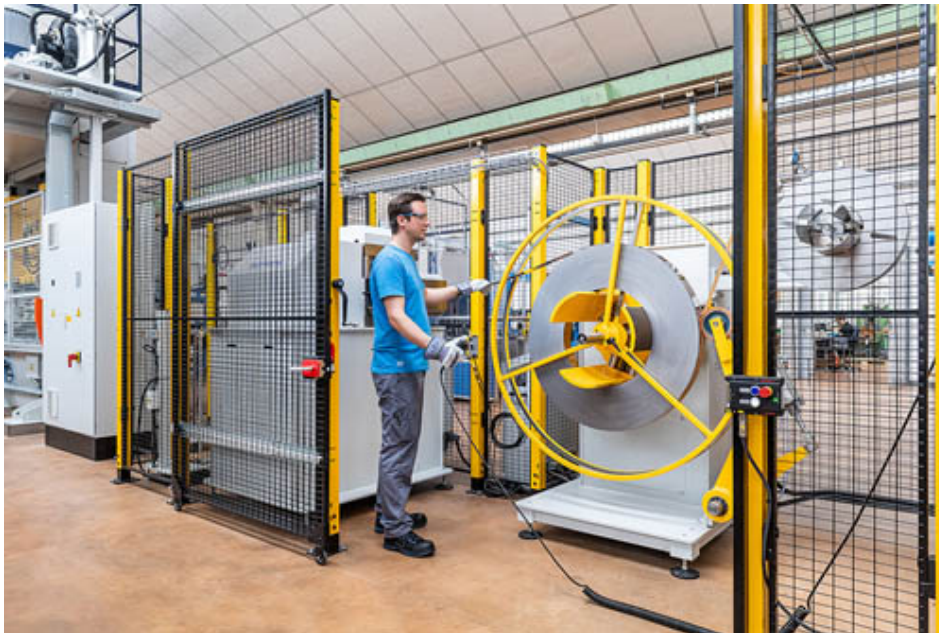
Bild Nr. 04-04 NI_Richtmaschine.jpg. Eine Feinrichtmaschine entspannt das bis zu vier Millimeter starke und 300 mm breite Metallband ab Coil und ermöglicht die Fertigung von Bauteilen mit höchsten Ebenheitsanforderungen.
