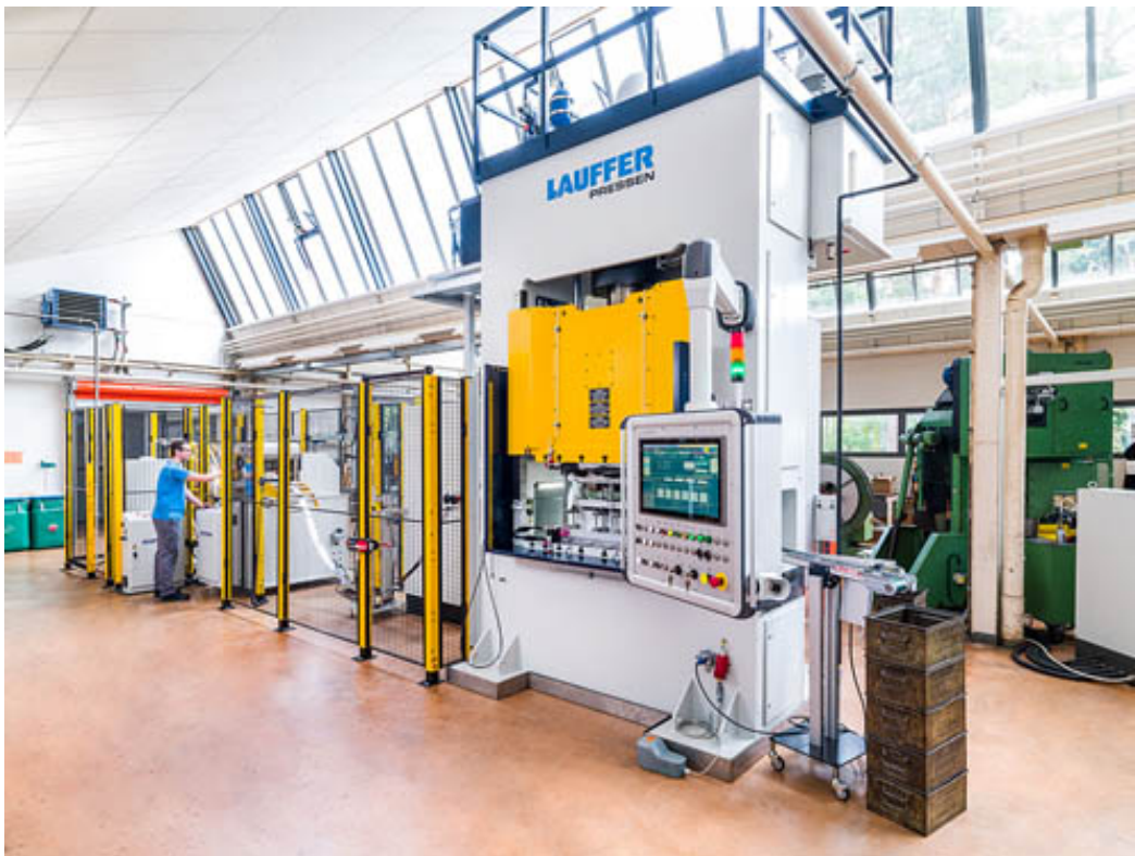
Bild Nr. 04-01 NI_Presse-1.jpg. Nägeli Swiss AG tätigt die größte Maschineninvestition der Firmengeschichte und nimmt eine hydraulische 200-Tonnen Presse für die Fertigung von Tiefziehteilen in Betrieb.
