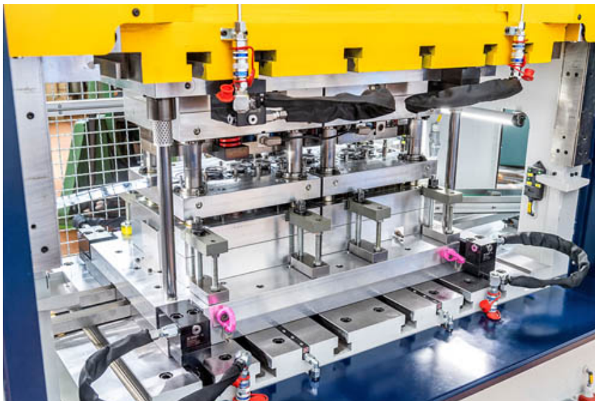
Bild Nr. 04-03 NI_Werkzeugraum.jpg. Durch den großen Werkzeugraum sind Ziehhöhen bis 150 mm möglich.
