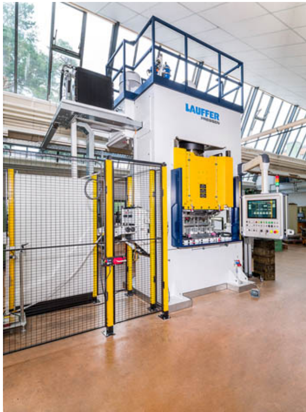
Bild Nr. 04-02 NI_Presse-2.jpg. Mit 2000 kN Presskraft, einem Ziehkissen mit gesteuerter Gegenhaltekraft und einem steuerbaren Umformverlauf lassen sich komplexe Umformungen in hoher Teilequalität fertigen.
