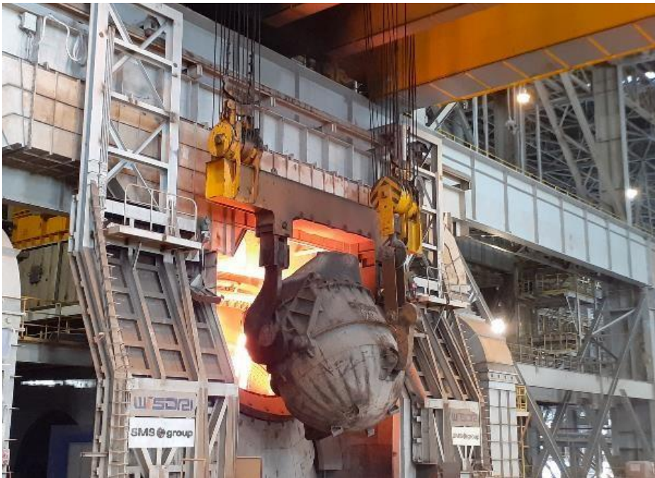
Der vierte von vier von der SMS group gelieferten BOF-Konvertern.
