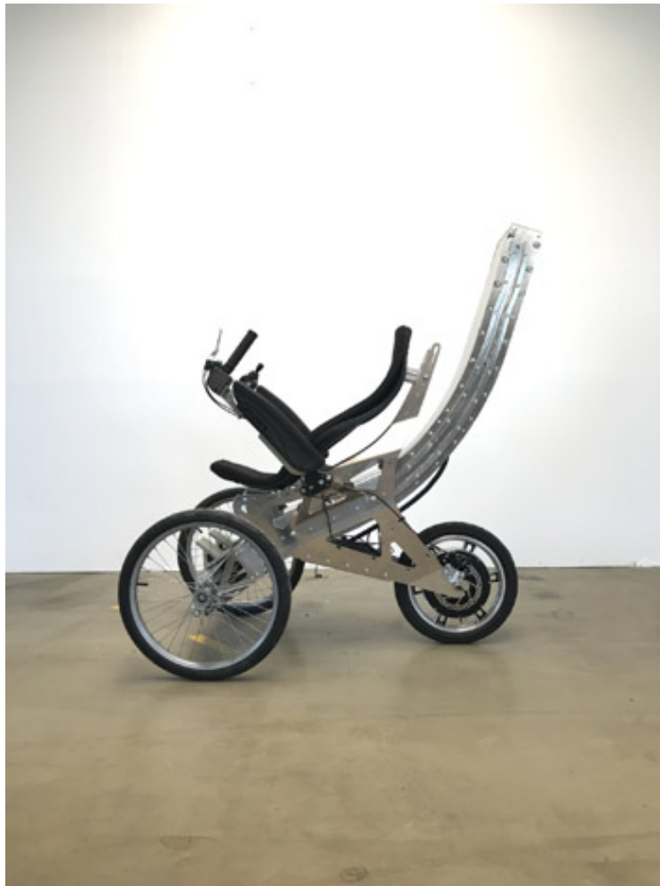
Bild Nr. 10-04 KY_L4Y-WMT-SitDriver-klapp.jpg Mit wenigen Handgriffen verwandelt sich der SitDriver in einen kompakten Sitz oder eine Art „Rollkoffer“. Ebenso lässt er sich komfortabel transportieren oder platzsparend verstauen.
