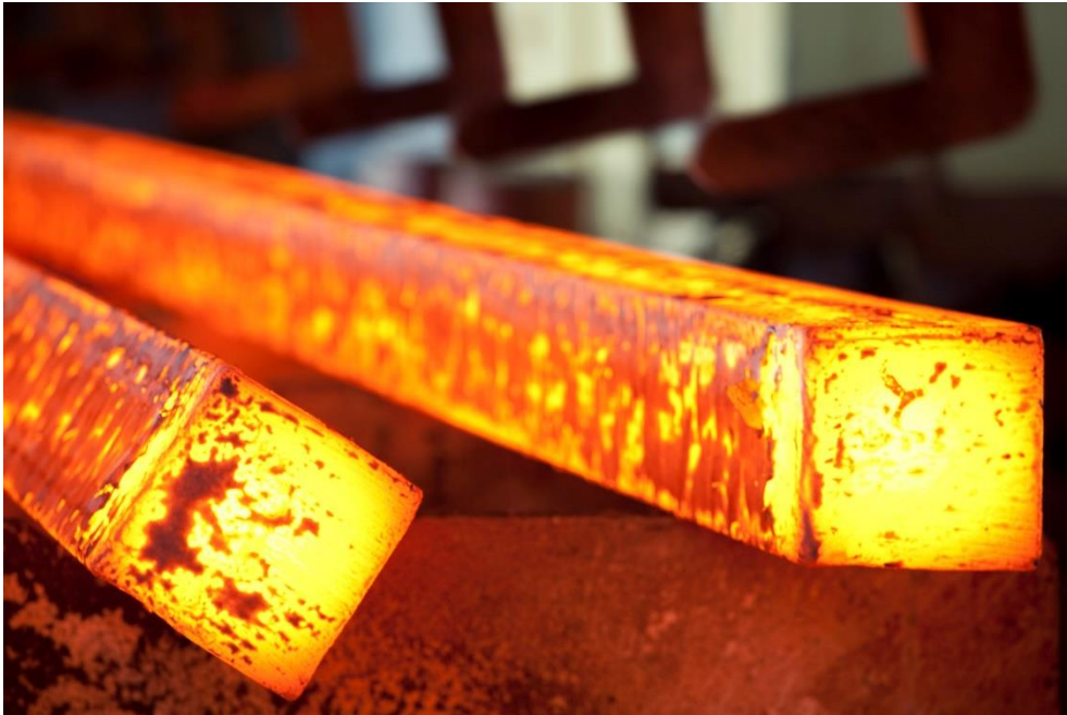
Knüppel, die auf einer SMS Concast-Stranggießanlage hergestellt wurden.
