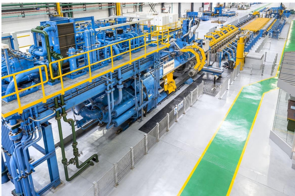
Mit der SMS-Schwermetall-Strangpresse (45 MN) fertigt WEM Zirkonium-Vorrohre.
