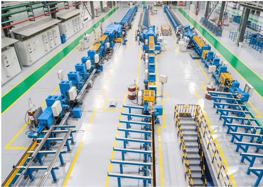
WEM betreibt bereits drei Kaltpilgerwalzwerke und eine Strangpresse von SMS.
