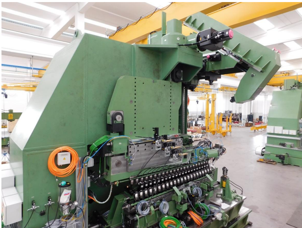
Das Herzstück der SMS-Spiralformanlage, die Rohrformstation.
