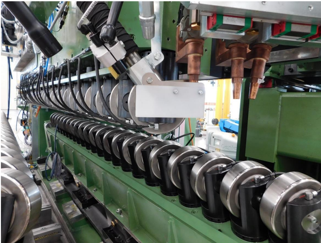
Die Drei-Rollen-Biegeeinheit der Rohrformstation von SMS im Detail.
