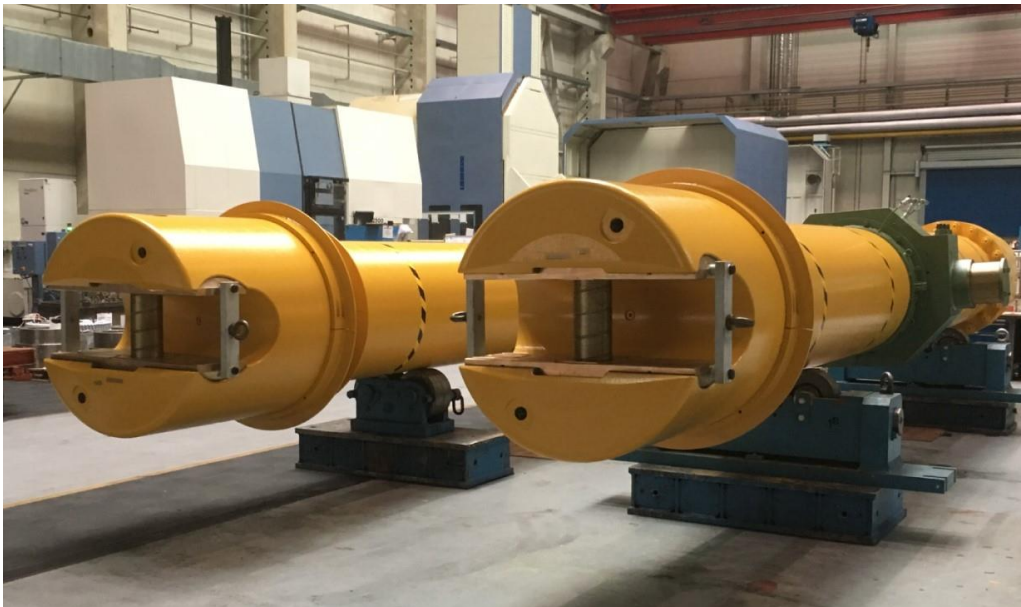
SMS-Flachzapfenspindeln sichern höchste Drehmomentübertragungen. (Bild aus der Werkstattmontage).
