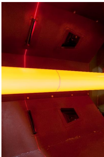
Laserbasierte Lichtschnittmessung mit dem PROgauge-System von TBK.
