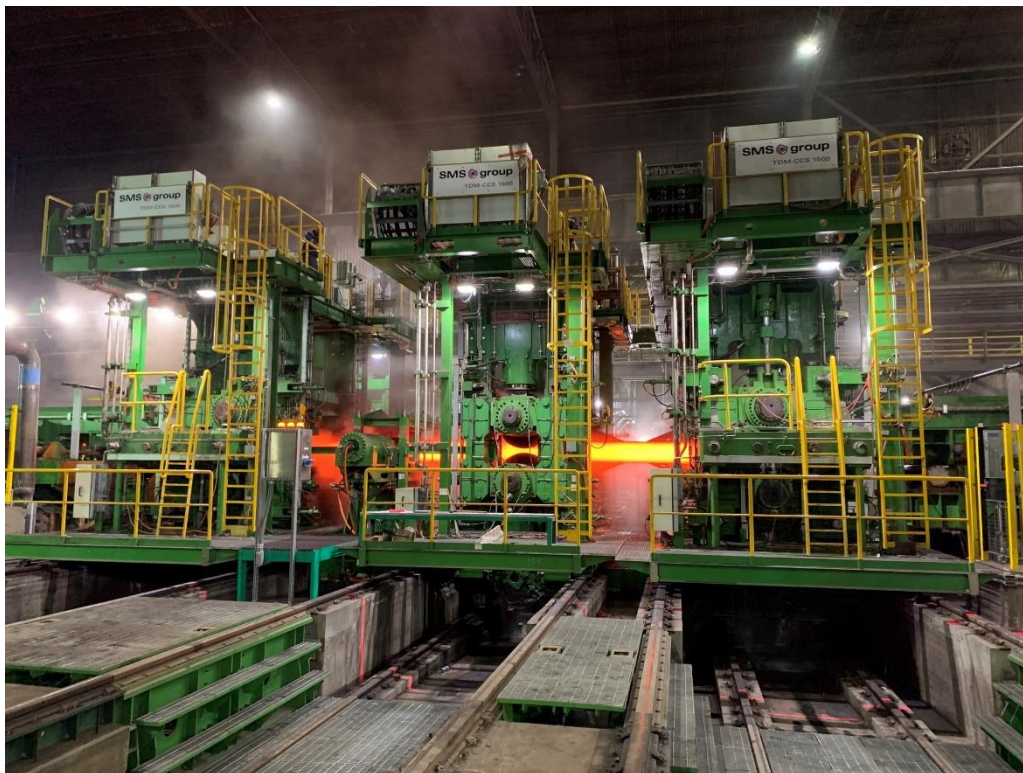
Neue dreigerüstige CCS®-Tandem-Reversieranordnung.
