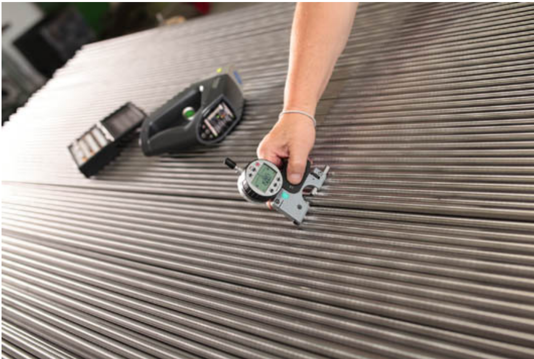
Bild Nr. 02-03 FL_Rundheitsmessung.jpg Protokollierte Rundheitsmessungen gehören zum Serviceangebot von STAINLESS FRÜCHTL.
