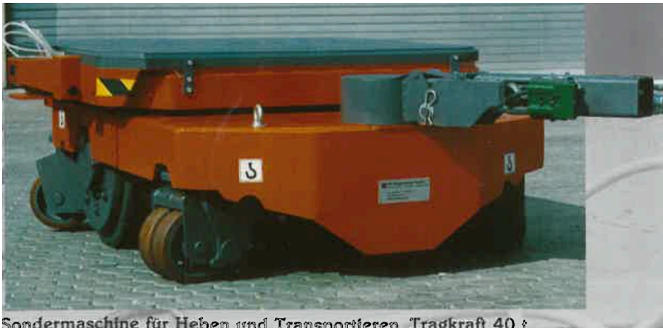
Sondermaschine für Heben und Transportieren, Tragkraft 40 t
