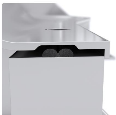
Beim Verschrauben des Batteriegehäusedeckels wird die elastische Schaumstoffzellenstruktur der Dichtung zusammengedrückt. Beim Öffnen stellt sich die Schaumdichtung nahezu komplett zurück.
