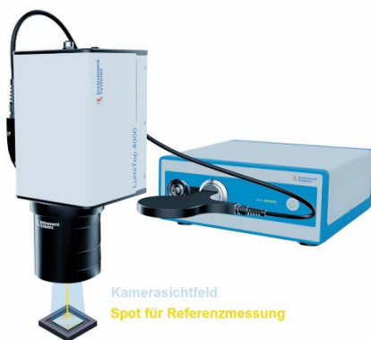
Abbildung: Das LumiTop-System umgeht den Erwärmungseffekt von Hochleistungs-LEDs durch simultanes Messen aller Farbkanäle und aller Einzelemitter in einer einzigen Aufnahme.
